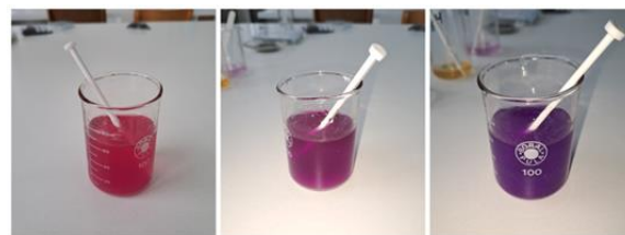
Slika 6. Određivanje kalcijuma pomoću Palintest SK 300® analizera zemljišta
