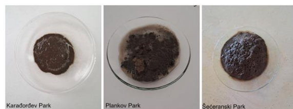
Slika 8. Određivanje sadržaja \text{CaCO}_3 u zemljištu
