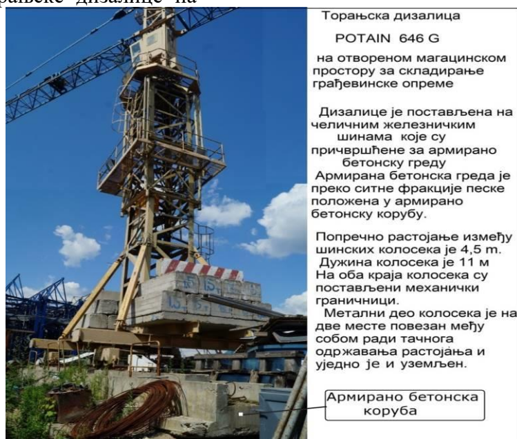
Сл.7 Торањска дизалица постављена на железничким шинама монтираним на армирано бетонским гредама уложених у армирано бетонским корубама
