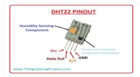
Slika 1. DHT22 senzor za merenje temperature i vlažnosti vazduha [3].
