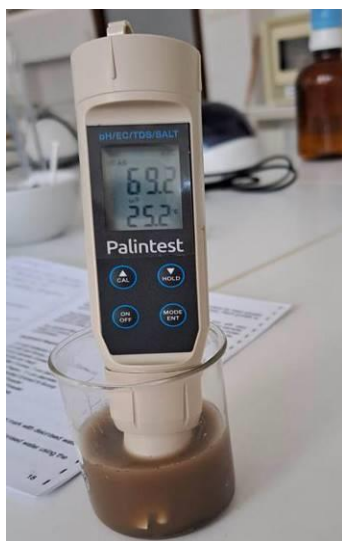
Slika 7. Očitavanje provodljivosti zemljišta i pH vrednosti
