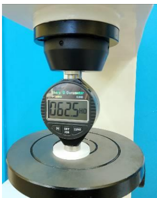
Слика 5. Мерење тврдоће ПЕТ-Г дела
