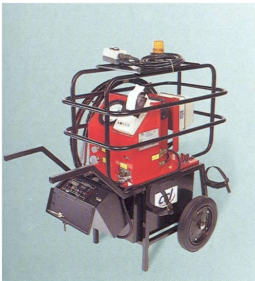
Слика 3. Преса и уређај за контролу силе преднапрезања
