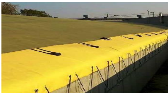
Slika 2. Poluzatvoreni sistem kompostiranja sa semipermabilnom membranom
