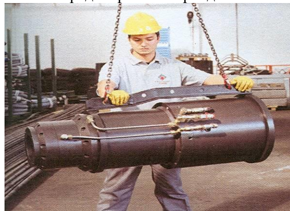
Слика 2. Пресе за преднапрезање снопа стрендова у каблу одједном
