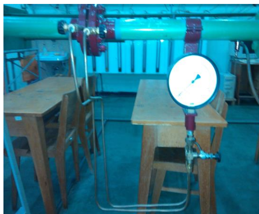
Slika 1. Membranski diferencijalni manometar, priključen na Mernu blendu
