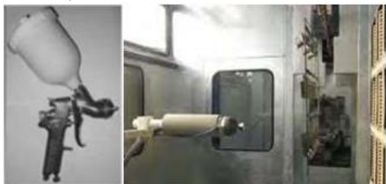
Слика 12. Метода наношења прскањем: а) конвенционални б) електростатички пиштољ за прскање [4, 5]
