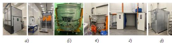
Слика 16. а) Аутоматска линија „TULZ 155“, б) резервоар за препарат „Zintek 200 ХТ“, в) резервоар за силер „Zintek TOP“, г) комора за хлађење; д) пећ за запецање ламеларног цинка и силера [8]
