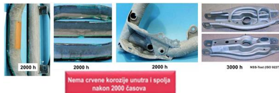
Слика 15. Резултати испитивања корозионе постојаности делова потапањем и цеђењем за аутомобилску индустрију [4, 5]
