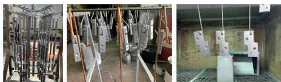
Слика 20. Делови после nanoшења превлаке ламеларног цинка прскањем "Zintek 400"
