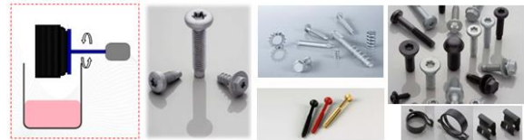
Слика 10. Побољшана опрема за ламеларно цинковање потапањем и центрифугирањем и делови израђени у масовној производњи [4, 5]
