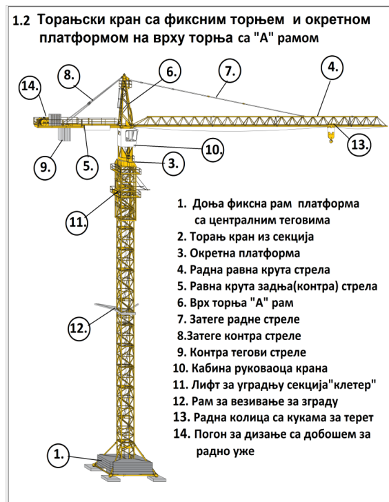
Сл.2 Торањски кранови са фиксним торњем
