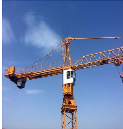
Сл.4 Торањски кран са равном крутом стрелом и затегама, стрела са „А“ рамом
