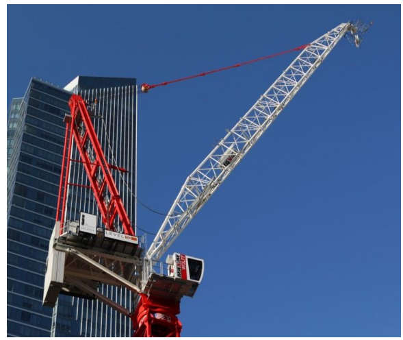
Сл.7 Торањски кран са фиксним торњем
