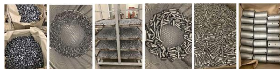
Слика 21. Делови после nanoшења превлаке ламеларног цинка у бубњу
