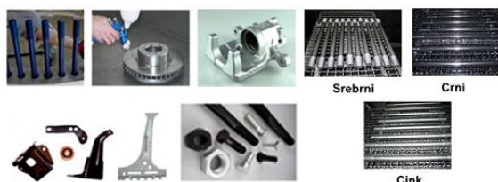
Слика 13. Примери наношења ламеларног цинка поступком прскања [4]
