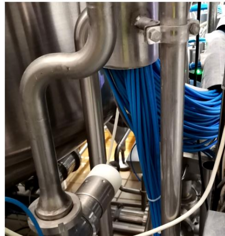
Слика 4. Спровођење снопа црева кроз посебне цеви
