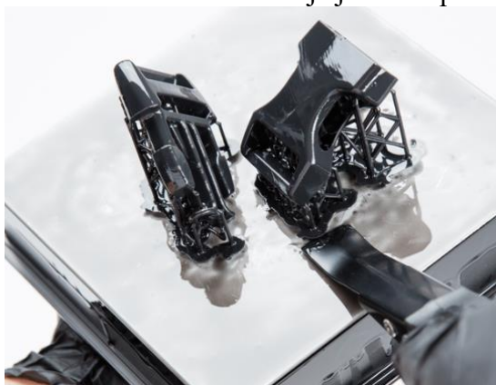
Слика 3а. Алат за одвајање одштампаног дела са платформе
