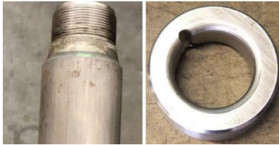
Слика 8. Оштећење површине клипа и седишта кугличног вентила [16]
