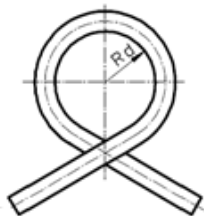
Слика 7б. Одређивање радијуса савијања који не омета проток
