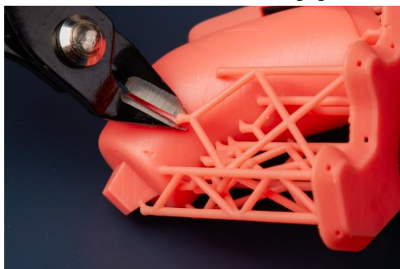
Слика 3б. Уклањање подршке сечицама
