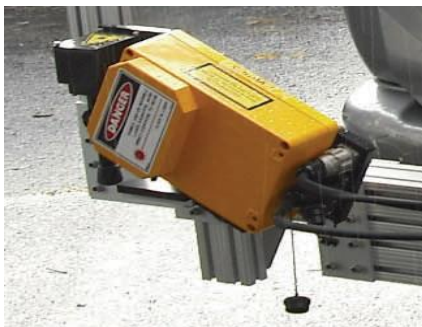
Слика 2. Приказ монтираног ROMDAS система [6]
