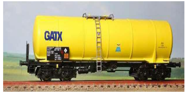
Слика 2. Резервоар вагон цистерне директно ослоњен на доње постоље
