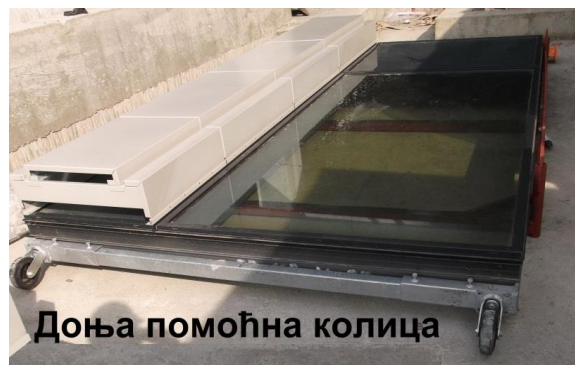
Слика 8. Помоћна колица за лакше подизање и исправљање
