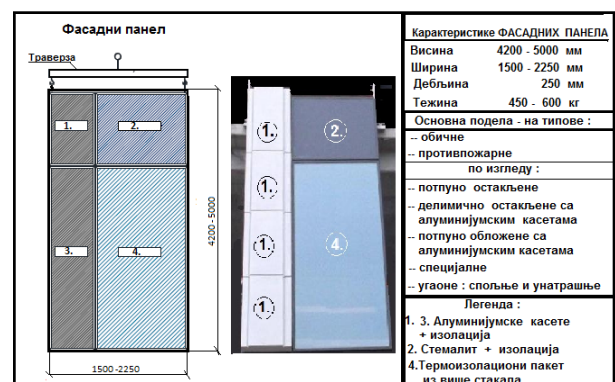
Слика 4. Техичке карактеристике Фасадног панела
