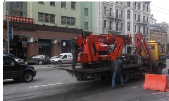
Слика 20. Допремање малог гусеничног крана на градилиште у Москви
