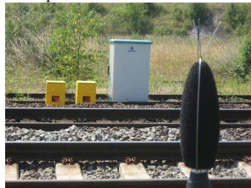
Слика 17. GOTCHA систем праћења оптерећења воза, неуравнотежења, динамичког удара и дефеката точкова [37]
