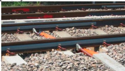
Слика 15. WILD WheelChex систем инсталиран на железничкој мрежи Велике Британије [35]
