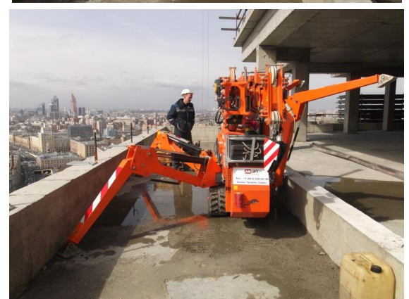
Слика 23. Подешавање ослоних „ногу“ за радни положај монтаже
