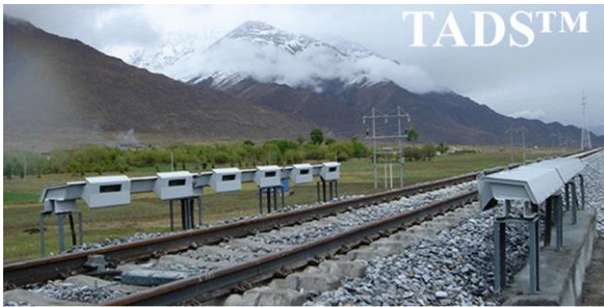
Слика 9. Систем за акустичну детекцију неисправности лежајева TADS [29]
