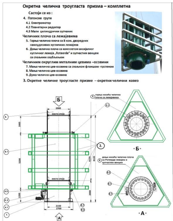
Слика 8. Скица челичне троугласте призме - комплетног елемента (првог монитора) са погоном и лежајевима, челичном цевном осовином са фланцем за везу са фундаментом
