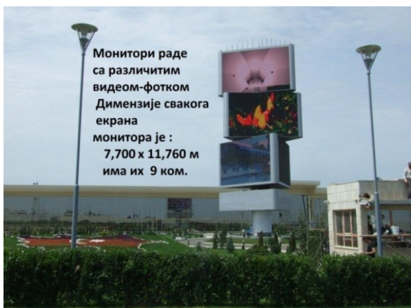
Слика 5. Окретни тространо призматични, тростепени блокови монитора – са емитовањем различитих фотографија
