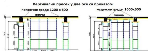
Слика 4. Различите висине скупина носеће металне конструкције PSK-CUPLOK [1-2]
