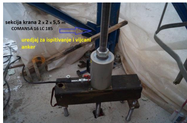
Слика 15. Хидраулични цилиндар - део уређаја за експертизу хемијског анкера унутар секције крана [4]
