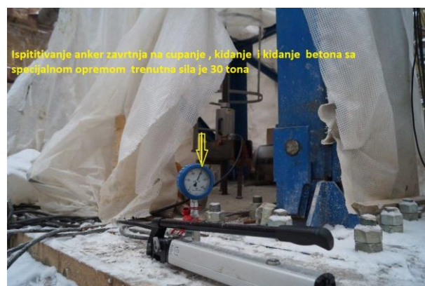
Слика 16. Испитивање чупања анкерног завртња са опремом МКЕ №1222260-002 силом од 300kN [4]
