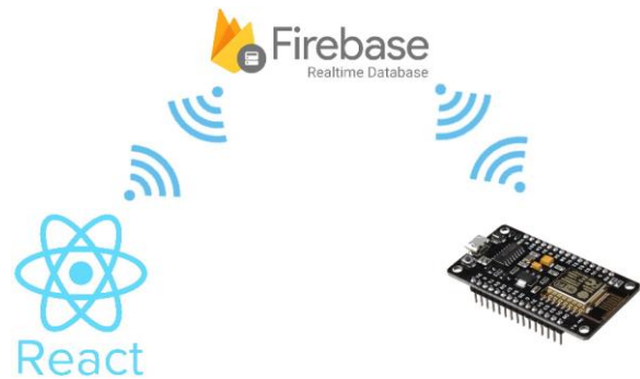
Slika 2. Veza NodeMCU, Firebase i React web aplikacije
