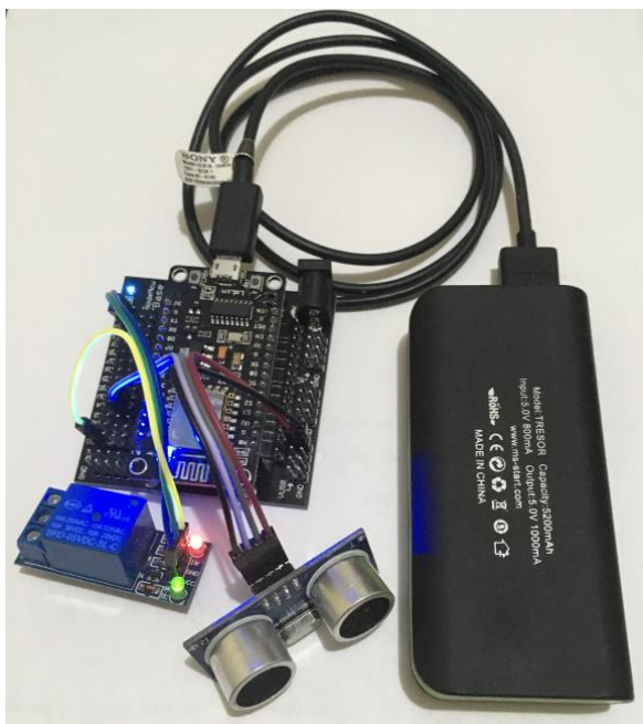
Slika 4. Veza NodeMCU, HC-SR04 senzora, releja i napajanja.
