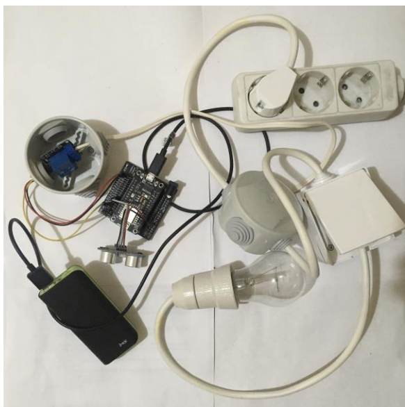
Slika 5. Veza NodeMCU, HC-SR04 senzora, releja, napajanja i potrošača - sijalice
