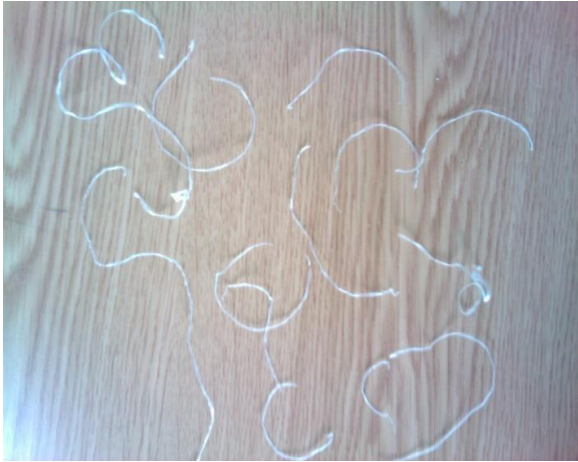
Slika 7. Merenje 6: ( a_p=1,5 mm; v_f=80 mm/min; n=1200 min -1 )
