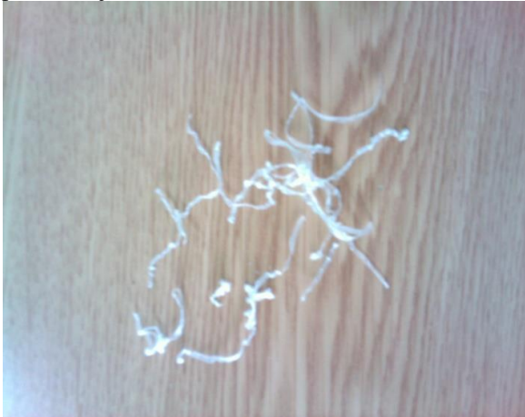
Slika 3. Merenje 2: ( a_p=2 mm; v_f=80 mm/min; n=1200 min -1 )
