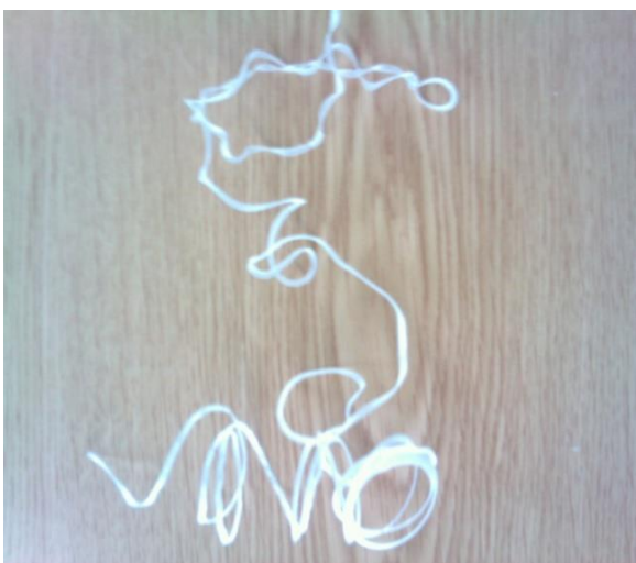
Slika 4. Merenje 3: ( a_p=2 mm; v_f=300 mm/min; n=600 min -1 )
