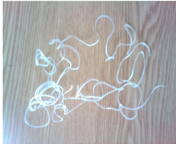
Slika 9. Merenje 8: ( a_p=1,5 mm; v_f=300 mm/min; n=1200 min -1 )
