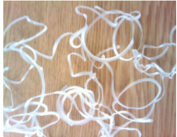
Slika 5. Merenje 4: ( a_p=2 mm; v_f=300 mm/min; n=1200 min -1 )
